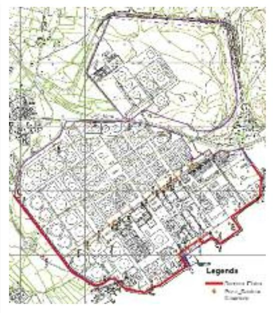
sto: la barriera dinamica, costituita da pozzi di emungimento dell'acqua di falda e recupero del surnatante.
