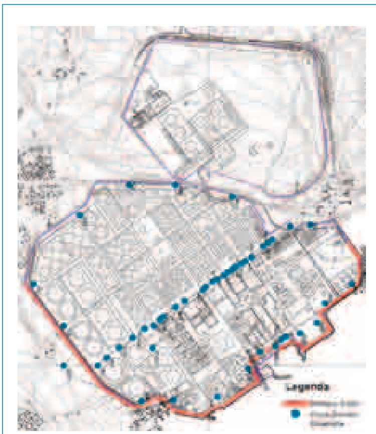
Figura 12 – Ubicazione dei pozzi costituenti la barriera dinamica e localizzazione prevista della barriera fisica
