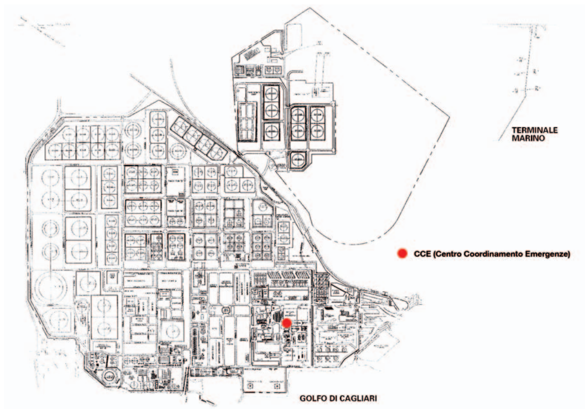
FIGURA 5 – LOCALIZZAZIONE DEL CENTRO COORDINAMENTO EMERGENZE DELLA RAFFINERIA
