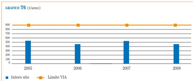
Gli interventi di installazione dei bruciatori a bassa produzione di NO<sub>x</sub>, effettuati nel corso del 2007 per i forni degli impianti Topping RT2 e Visbreaking, hanno consentito una sensibile riduzione delle emissioni dalla raffineria.
