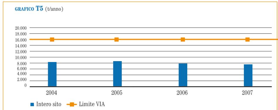
Una ulteriore riduzione (circa il 30%) delle emissioni di SO<sub>2</sub> dal sito è prevista con l'avviamento della nuova unità di trattamento dei gas provenienti dagli impianti di recupero dello Zolfo della raffineria, i cosiddetti "gas di coda" (intervento n°1 dell'elenco riportato nel cap.5 a pag. 26).
