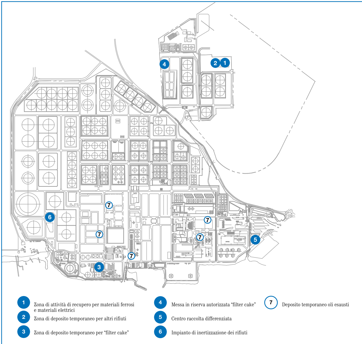
FIGURA 18 Aree dedicate alle principale attività per la gestione dei rifiuti nel sito.
